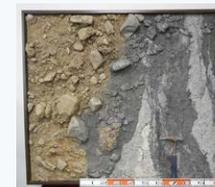
▲トレンチ調査による断層破砕帯の剥き取り標本
