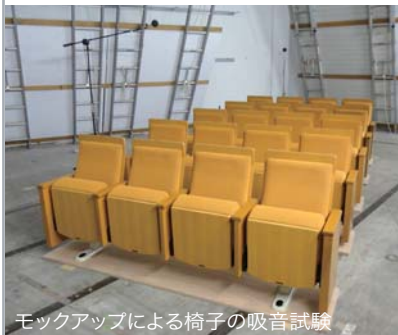
モックアップによる椅子の吸音試験
